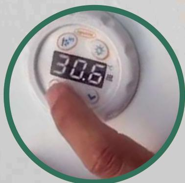
**Para acionar, precisa estar com as mãos secas e após programação, manter o visor tampado, verificar dentro da casa os disjuntores ligados da hidro, só ligar a hidro após banheira cheia de água, tem controle de temperatura e iluminação.**
